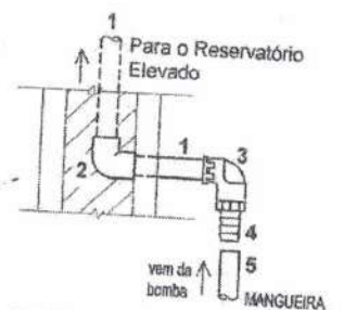
INST. HIDRÁULICA - Detalhes da Saída do Reserv. Inferior para o Reserv. Superior - Escala 1:10
